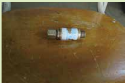
風炮仗仔(藍色)/ 回火器(氧氣) Flashback arrestor (Blue) / oxygen
